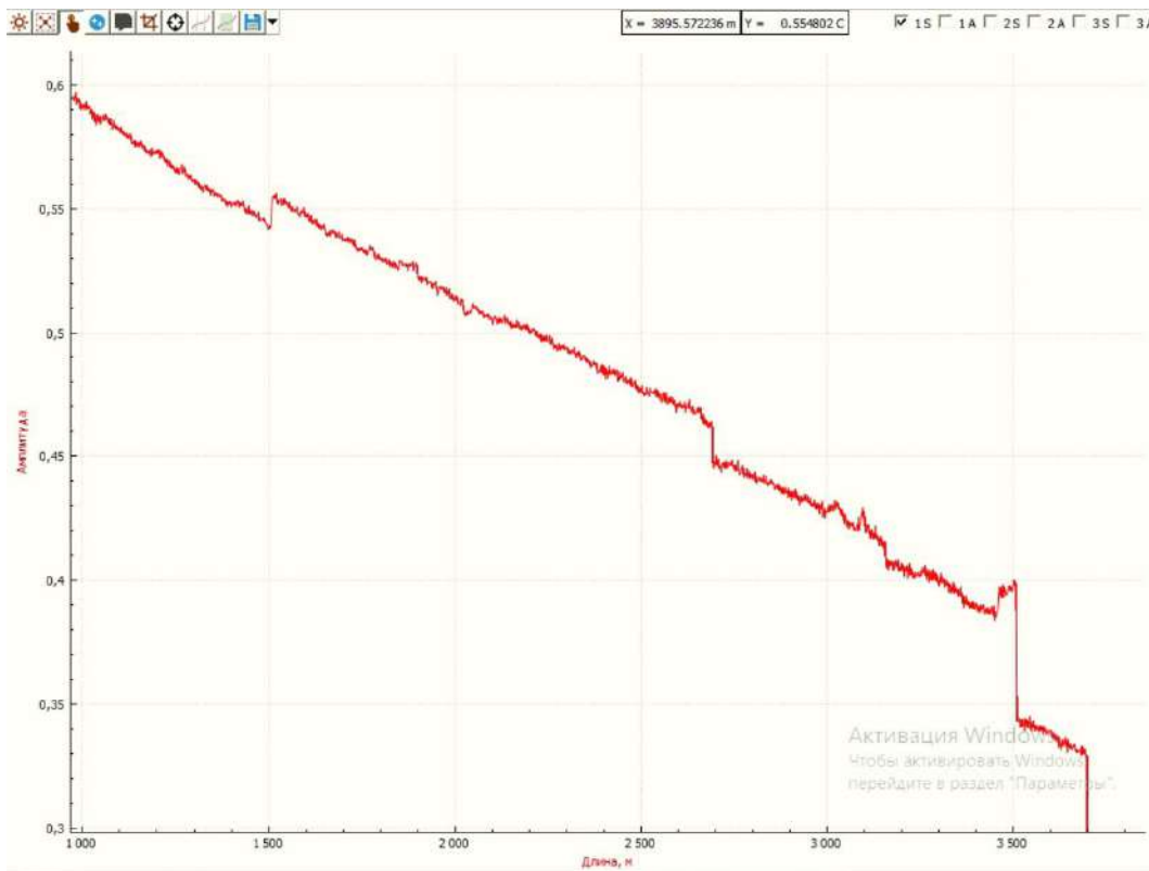
Рисунок Б.1 – Пример ступенчатого изменения затухания в волокне, как в сторону увеличения (окрестность 1500 метра)
